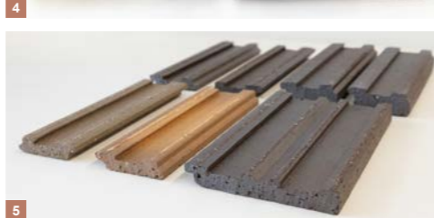
4 5 採用された還元焼成タイルの表面と裏面。手作り感、クラフト感のあるタイルは、シャープな建築に温かみをプラスする素材となった。6 タイルハンギングシステムのATH断面図。板体の最下段に必ず H137のタイルがくるように。また最上段は、板体のシーリングの打ち替えができるようにアイジャクリの先端をカットしている。二丁掛メイン形状は数量が多いので、金型をつくり、他の形状は現場でカットして施工する
