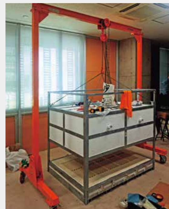
1 板ガラス溶着の実験炉 2 さまざまな曲率をもつ板ガラスの溶着サンプル [写真提供：佐藤淳構造設計事務所+東京大学佐藤研究室]
