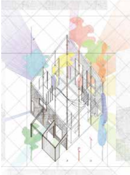
グリッド（2017）新興住宅地に建つ若い夫婦と子どものための住宅。敷地境界から45度振った2.73mグリッドの交点に、柱、植栽、ポスト、電柱など自然物と人工物が配置され、室内外をつなぐ。吹き抜けの玄関土間とリビングを中心に、寝室や水まわりが外周に配置される。スリット状のトブライトからの自然光は、柱間に張られた寒冷紗によって室内に拡散される
