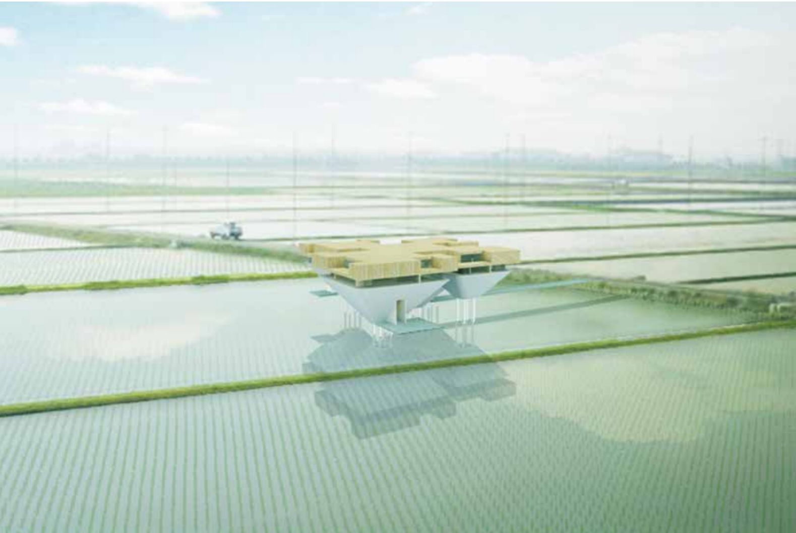
たんぼハウス／そこにある「田んぼ」を敷地として使うプロジェクト。鋼管杭に家を直結して浮かべ、耕地への影響を最小に抑えている【提供：大建設】
