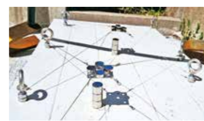
磁力耐震ブレースのコンセプトスケッチ [提供：江尻建築構造設計事務所]
