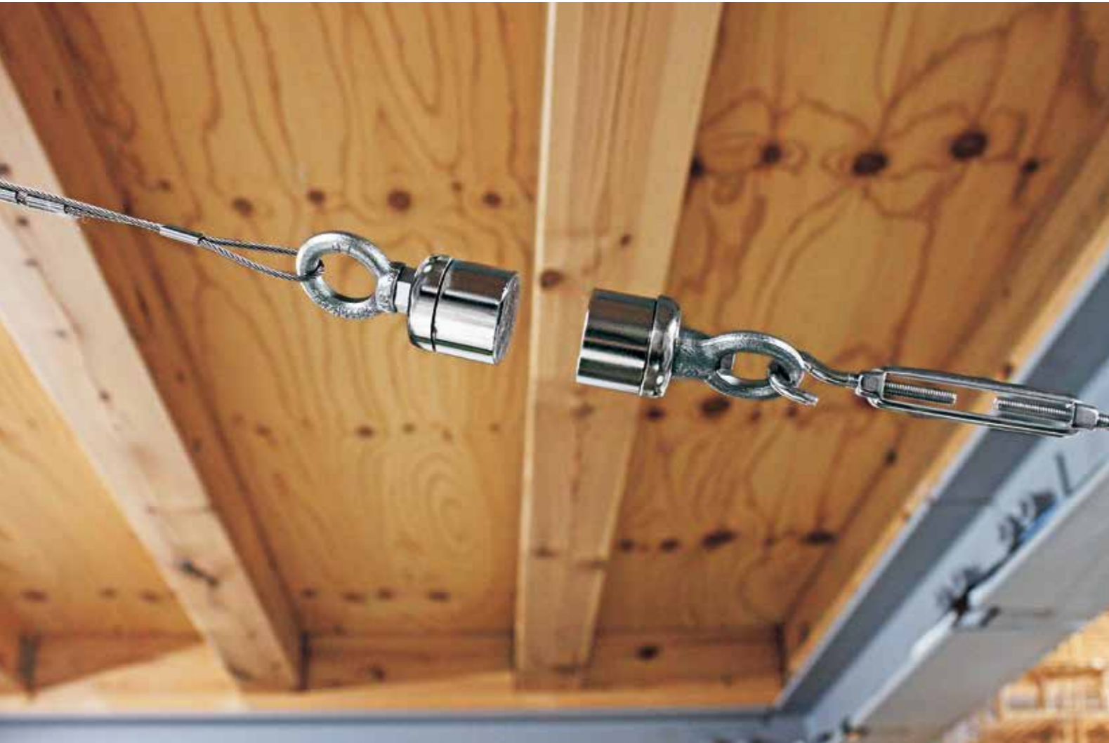
磁力で引き合う力を利用した耐震ブレースの実験モデル。中央のネオジム磁石の間は密着せず離れている [写真：編集室]
