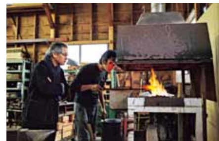
鑪(ふいご)でコークスを焼し、鉄棒を熱する藤田さんと火元を覗き込む私
