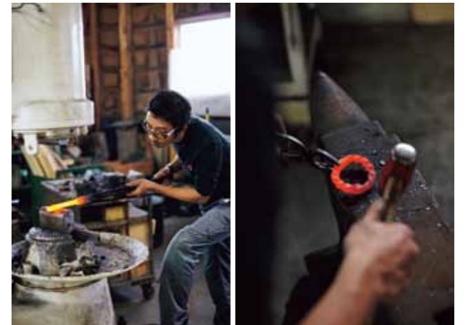
上—「美術鍛造・ふじたん」の工房の様子。奥にあるコークスの炉がなければ「鉄工場」という表現がぴったりのスペース | 下左—真っ赤に焼いた鉄棒を鍛造機(エアハンマー)で叩いて加工する、真剣な眼差しの藤田さん | 下右—熱して、叩いて、捻って作った鉄の輪っか。さて、何に使えますかね?、ペーパーウェイト?、ナブキンリング?、ちょっと違うなあ
